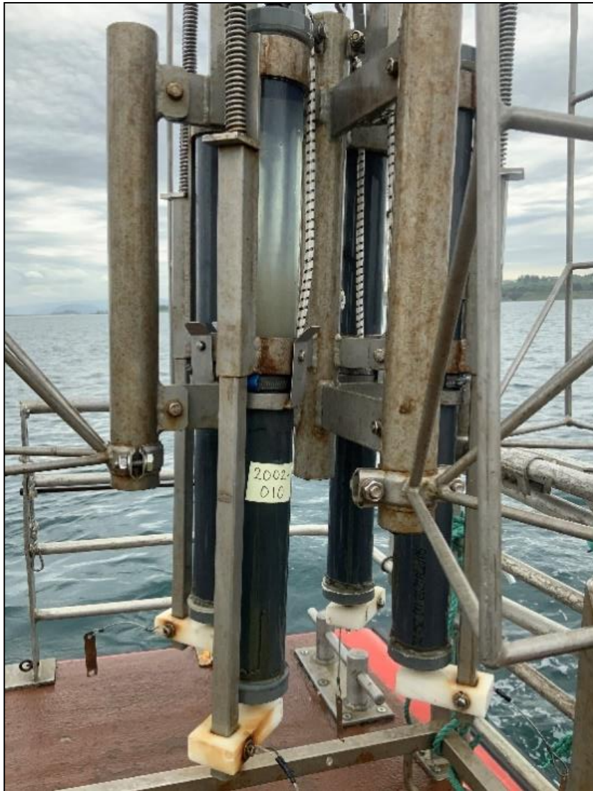
Figur 1. Prøvetaking med NGUs multicorer, som tar opptil 4 kjerner per stasjon. Lukkemekanismen utløses idet prøvetakeren treffer bunnen, og stenger topp og bunn av hvert rør. For hver stasjon er de øverste 2 cm av to kjerner brukt til analyser av sedimentenes kornfordeling og metallsammensetning.
