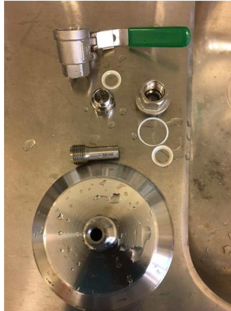
Typisk 45 mm stålfilter før og etter endringer
