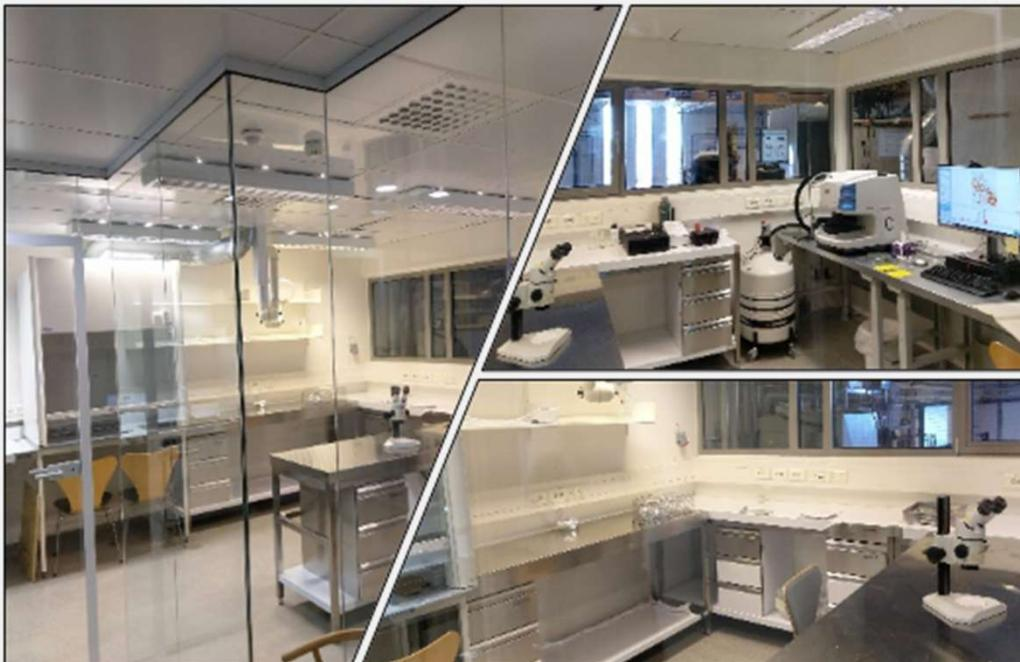
Plastlaben er utstyrt med et høyeffektiv ultra-lav gjennomtrengings HEPA-14H luftfiltreringssystem med >99% effektivitet mot innslipp av partikler ned til størrelsesorden 0.1-0.5  $\mu\text{m}$ .
